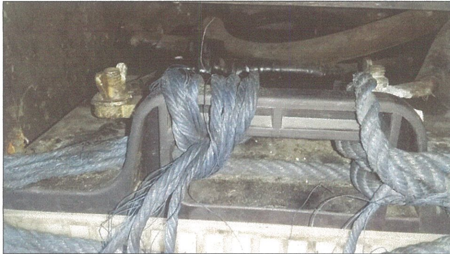
Gambar 13. Dudukan baterai menggunakan tali plastik sebagai pengikat
