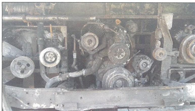
Gambar 4. Kompartemen mesin yang terbakar
