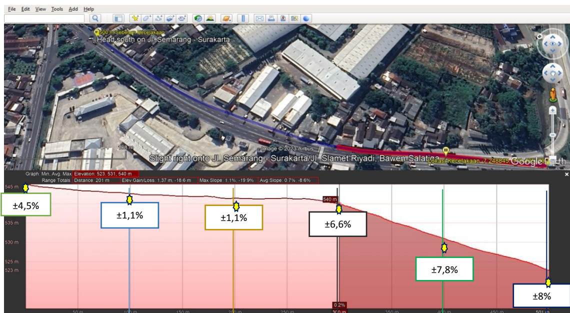
Gambar 9. Kondisi Kemiringan vertikal Jalan 500 meter sebelum lokasi kejadian
