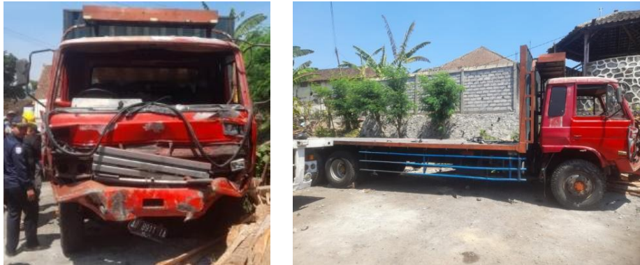
Gambar 4. Bagian kabin truk tronton mengalami deformasi
