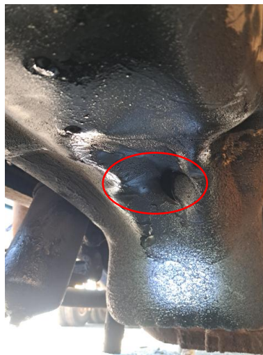
Gambar 5. Kondisi carter oli mesin dampak kecelakaan
