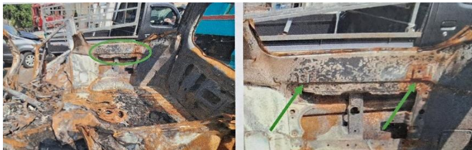
Gambar 13. Kondisi aktual posisi pengait kursi belakang mobil penumpang 1 yang terlibat kecelakaan
