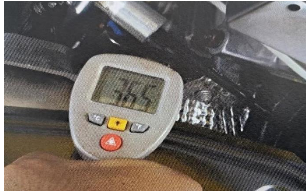
Gambar 12. Hasil pemeriksaan temperatur exhaust manifold pada kendaraan sejenis mobil penumpang 1
