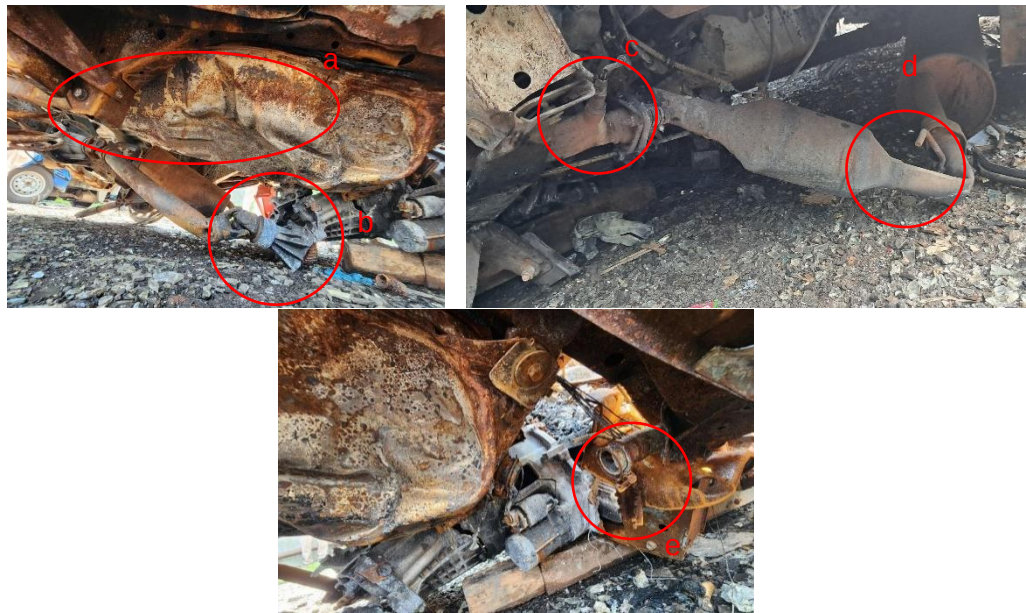
Gambar 9. Kondisi bagian bawah kendaraan dampak kecelakaan
