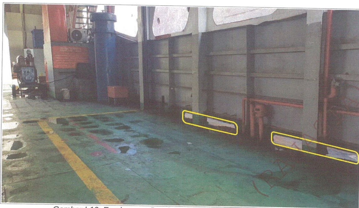
Gambar I-10: Freeing port (kotak kuning) di TPJ 3888. Gambar: KNKT.
