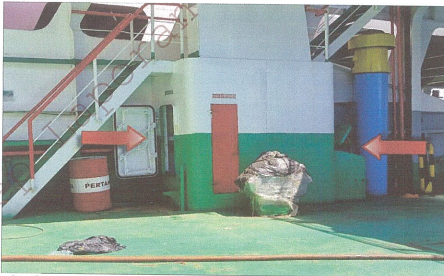
Gambar II-1: Contoh bukaan yang terbuka di kapal Tunu Pratama Jaya 3888. Gambar: KNKT.
