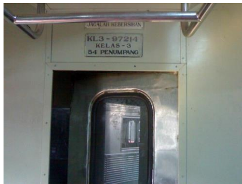
Gambar 4. Pintu kabin pada KL3 97214 tidak terkunci
