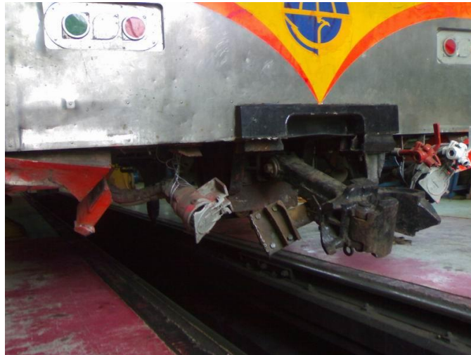
Gambar 3. Kerusakan pada KL3 97208
