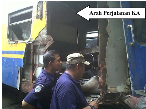
Gambar 3. Kereta K3 85554 rangkaian KA 144 yang mengalami kerusakan pada bodi ujung kiri belakang
