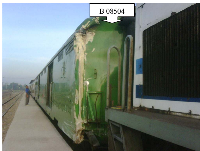
Gambar 4. Kereta bagasi B 08504 rangkaian KA 34 yang penyok sisi kanan depan
