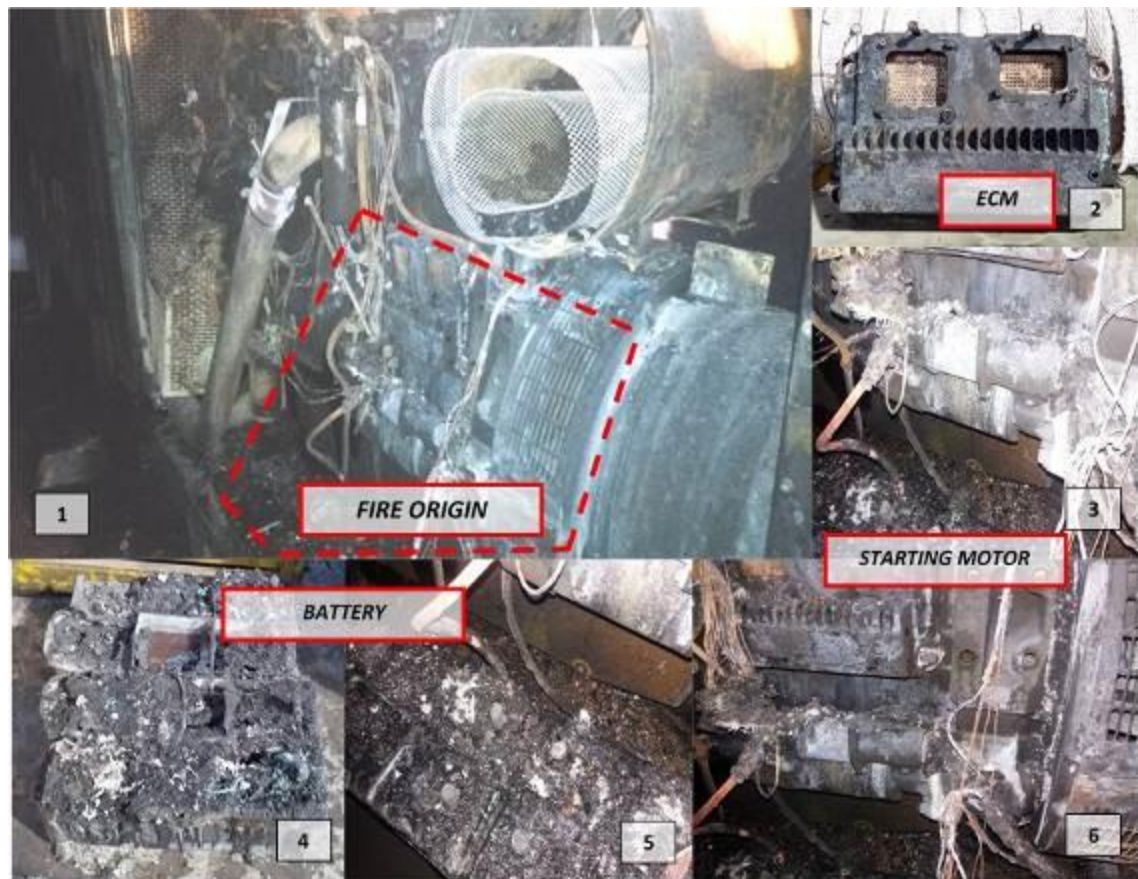
Gambar 30. Kemungkinan Fire Origin Pertama ( Engine )
