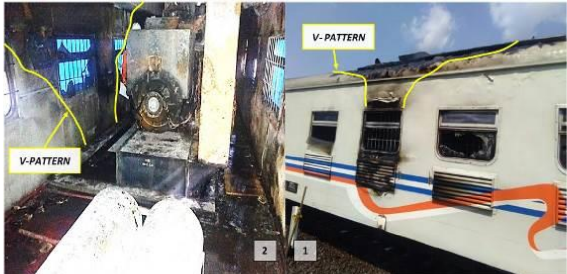
Gambar 28. Fire Pattern Kereta Pembangkit P06811
