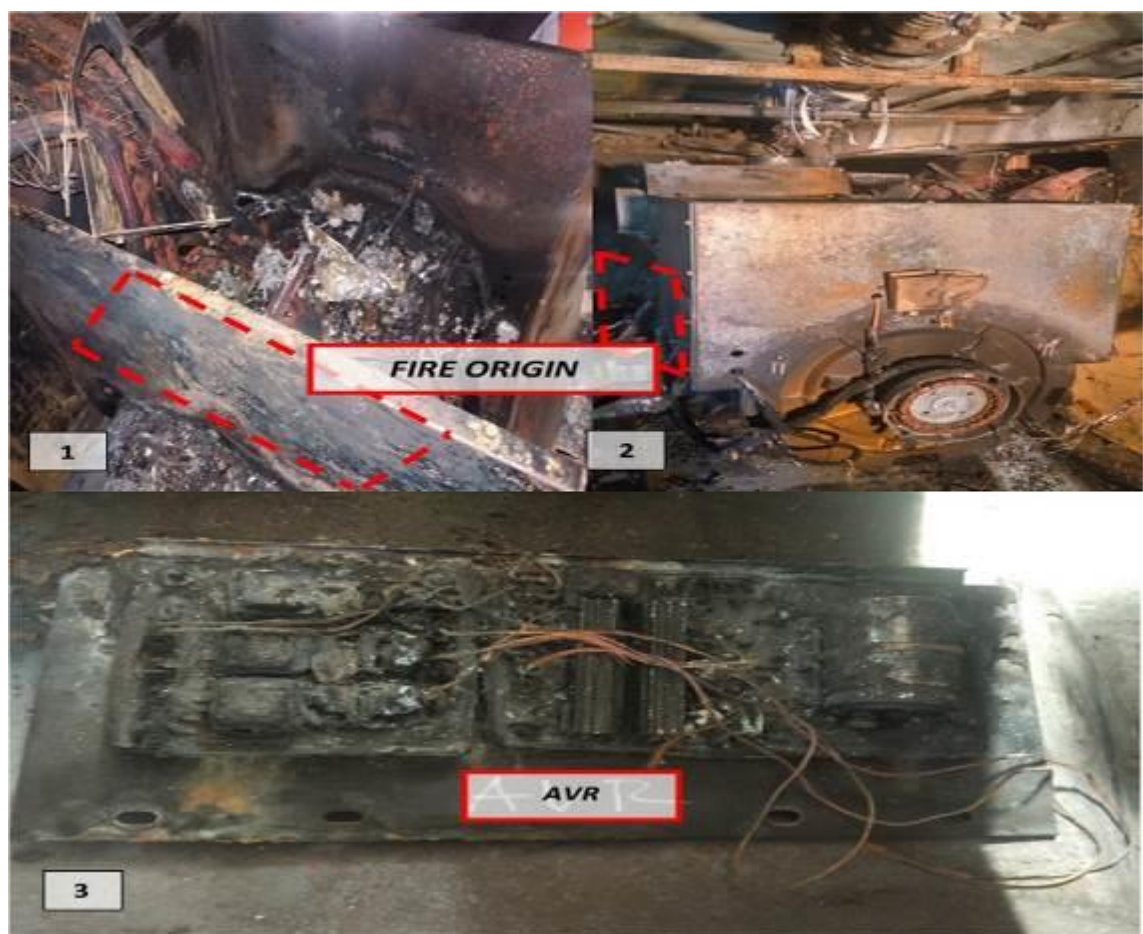
Gambar 31. Kemungkinan Fire Origin Kedua ( Generator )
