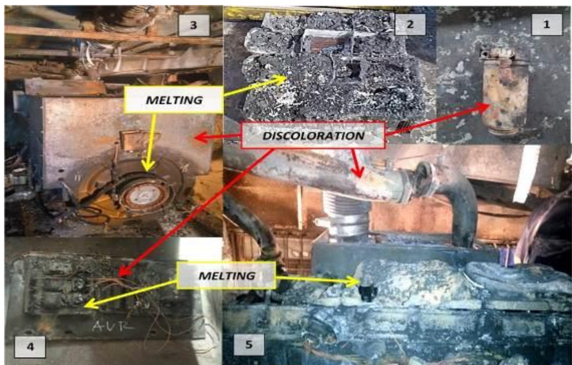
Gambar 27. Melting dan Discoloration
