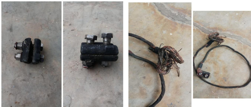
Gambar 7. Clamp dan Connector TM rusak
