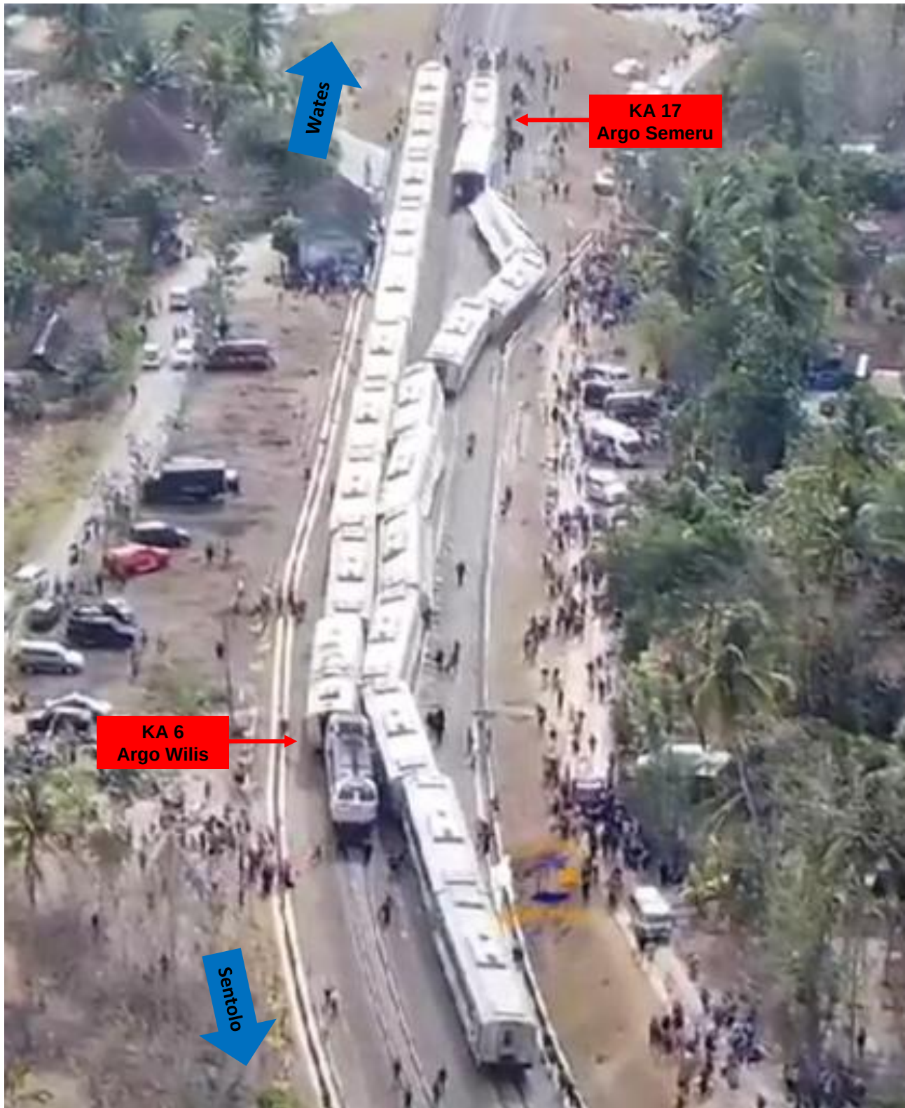
Gambar 1. Anjlok KA 17 Argo Semeru dan insiden tabrakan antara rangkaian KA 6 Argo Wilis dan rangkaian KA 17 yang anjlok di KM 520 + 420 petak jalan antara Stasiun Sentolo – Stasiun Wates, Daop 6 Yogyakarta
