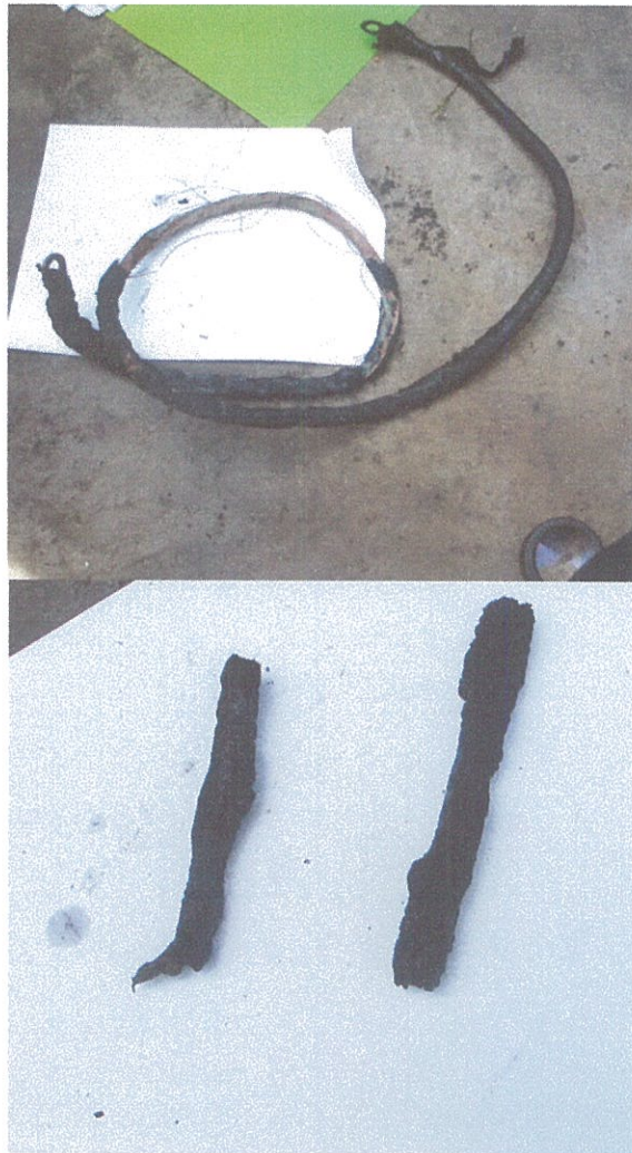
Gambar 5. bungkus kabel baterai terbakar
