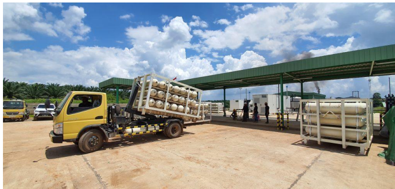
Gambar 3. Foto truk CNG sejenis yang dilengkapi dengan hydraulic arm roll
