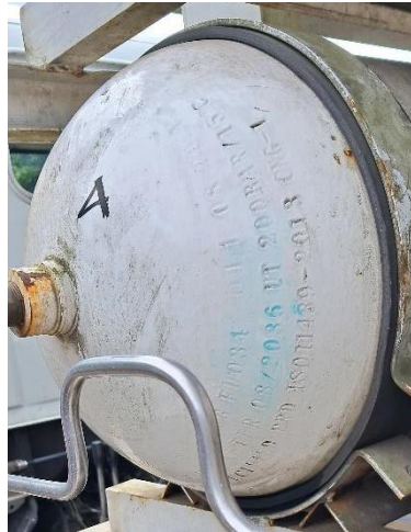
Gambar 21. Informasi yang ada pada badan tabung CNG
