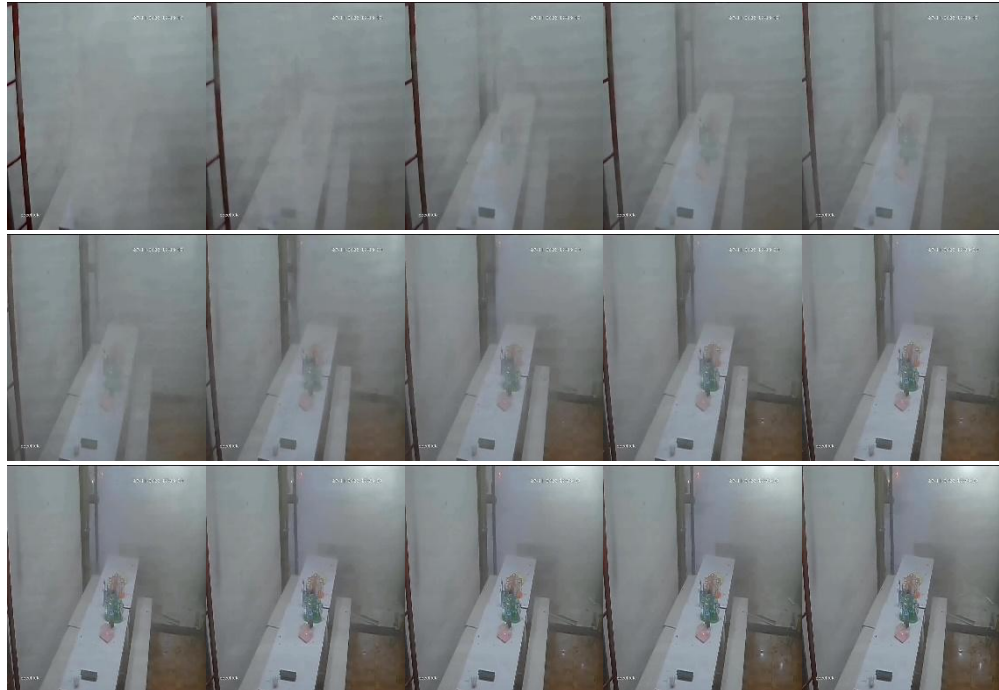
Gambar 11. Pressure wave akibat ledakan tabung CNG berjarak \pm 15 meter
