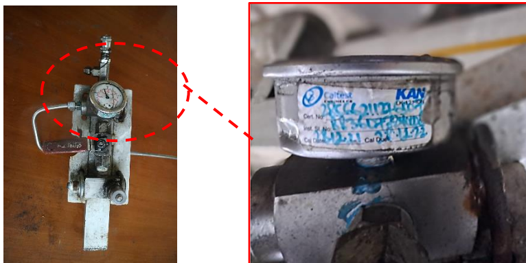
Gambar 20. Kalibrasi manometer berlaku sd tanggal 22 Desember 2022
