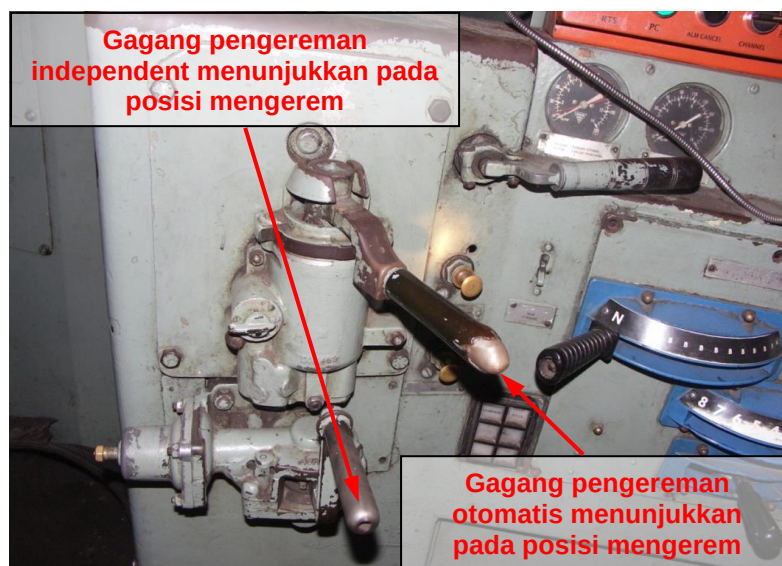
Gambar 6. Posisi gagang pengereman otomatis dan gagang pengereman independent pada kabin masinis KA 3516A
