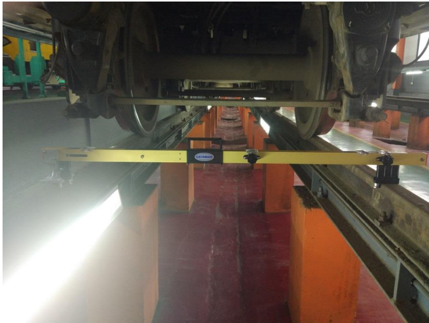
Gambar 15. Pengambilan data pelebaran dan pertinggian di jalur perawatan Depo KRL Bukit Duri
